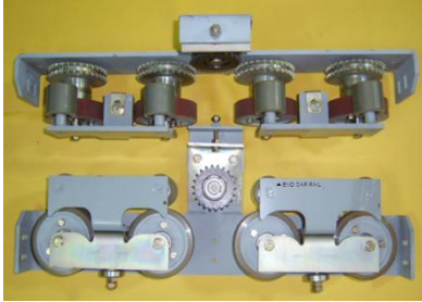
1. LG-OTIS 인천 HR 구동장치
