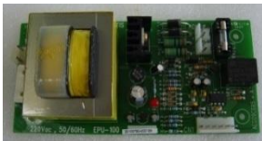
5. OTIS EPU-100 비상전원장치 제어부
